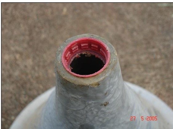
Figura 4. Fixação da rosca no vértice do funil com cola plástica.
