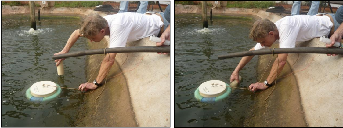
Figura 7. Momento em que o ar no interior do cilindro é transferido para o interior da câmara.
