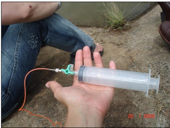
Figura 8. Ar sendo aspirado com auxílio da seringa e dos canalículos de transferência dos gases. Detalhe do divisor múltiplo na ponta da seringa.
